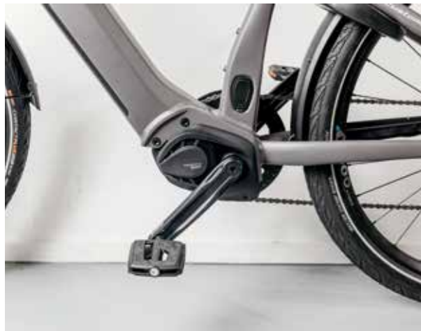
Zentraler Schwerpunkt dank Mittelmotor
