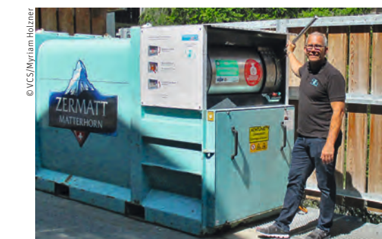
Hebel runterziehen, Abfallsack einwerfen, Hebel nach oben gleiten lassen: Matthias Schwendimann demonstriert das einfache System.
